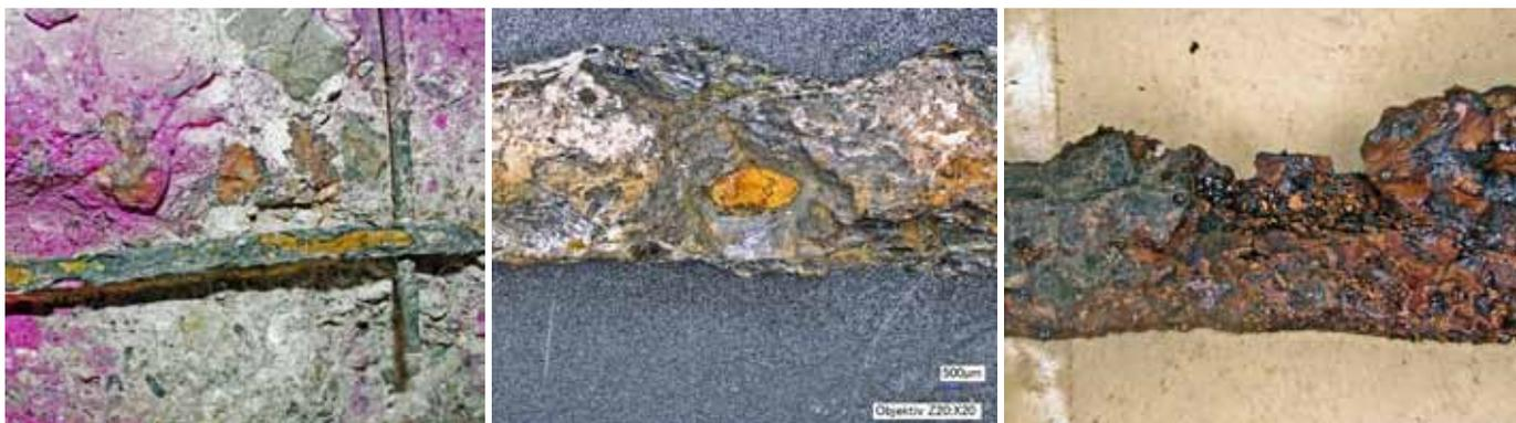
Abb. 3-5: Die durch Chlorid ausgelöste Lochfraßkorrosion ist oft lokal begrenzt.
