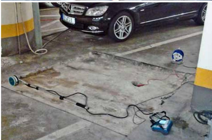
Abb. 7/8: Mit einer Potenzialfeldmessung können gezielt diejenigen Stellen für die Probenahme lokalisiert werden, an denen aktuell eine Stahlkorrosion abläuft.
