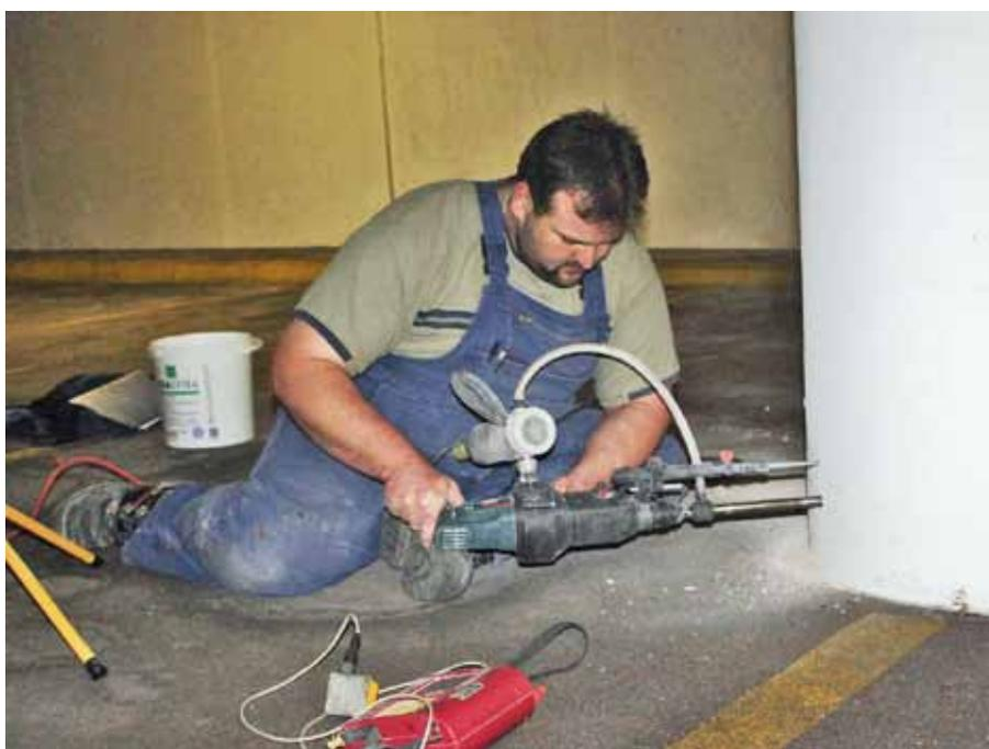
Abb. 6: Für einige Schnellprüfverfahren wird Bohrmehl aus dem Bauteil entnommen.
