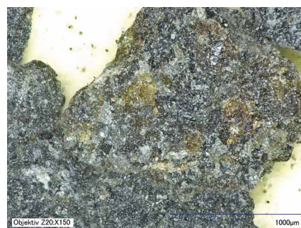
Abb. 6a+b: Fugenmaterialien mit Hinweisen auf mobilisierbare eisenhaltige Bestandteile
