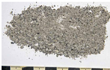
Abb. 5a+b: Auswahl von untersuchten Fugenmaterialien. Schlacke mit geringem Feinanteil (oben) und Splitt-/Sandgemisch mit einem hohen Feinanteil (unten)
